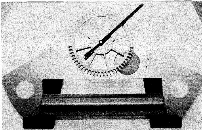
Modell des **Schrittmotors**, wie er für die "Swatch" verwendet wird. Unten die Spule, darüber das Joch aus weichmagnetischer Nickel-Eisen-Legierung, exzentrisch der Rotor aus Samarium-Cobalt, der direkt das Räderwerk antreibt.
