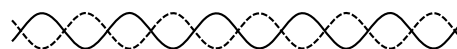
Abbildung 13: Bei einer stehenden Welle bleiben die Nullstellen (Knoten) fix und die "Bäuche" schwingen harmonisch.
